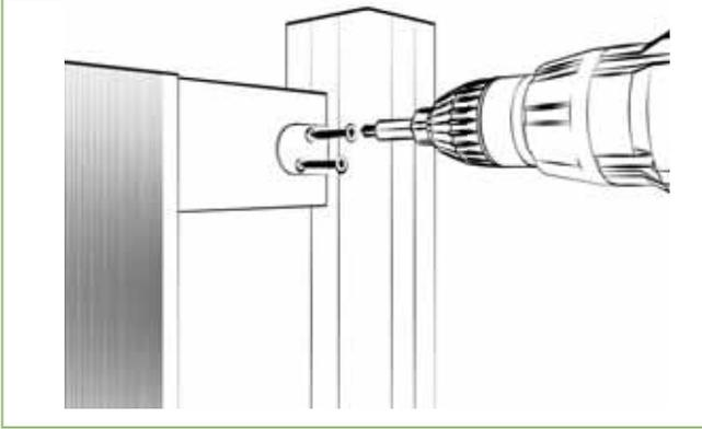
3c | Die Befestigungswinkel werden von hinten mittig an dem Aluminiumquerriegel befestigt. Die Schraublöcher mit einem 3 mm Bohrer vorbohren!
