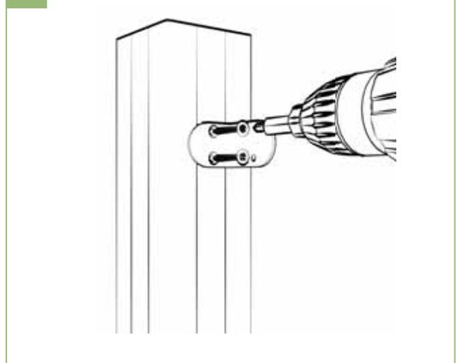
3b | Die Befestigungswinkel mit den mitgelieferten Schrauben am Pfosten befestigen. Die Schraublöcher mit einem 3 mm Bohrer vorbohren!
