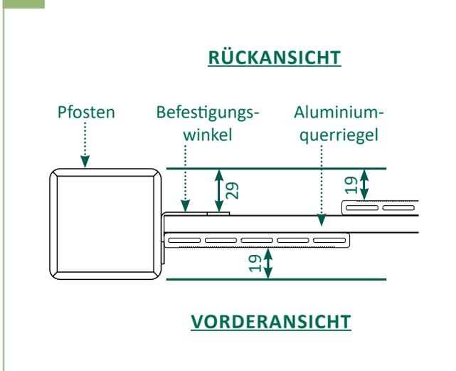
3a | Die Befestigungswinkel werden mit je zwei lange Schrauben am Pfosten und je zwei kurze Schrauben an den Querriegeln der Zaunelemente befestigt. Die Befestigungswinkel mittig vom Querriegel anbringen.
