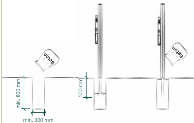
1 | Größe der Fundamente mindestens 300 x 300 x 800 mm sowie unter Berücksichtigung der Bodenbeschaffenheit.\* Ungefähr die Hälfte des Erdloches mit Beton füllen und verdichten. Anschließend die Pfosten setzen und ausrichten. Das Erdloch komplett mit Beton füllen und verdichten.
